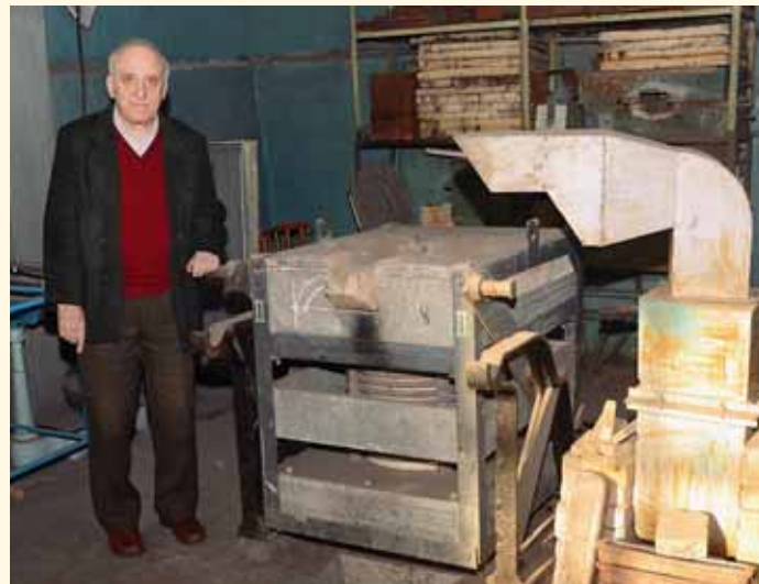
Плавильна лабораторія. Індукційна піч ICT-016
